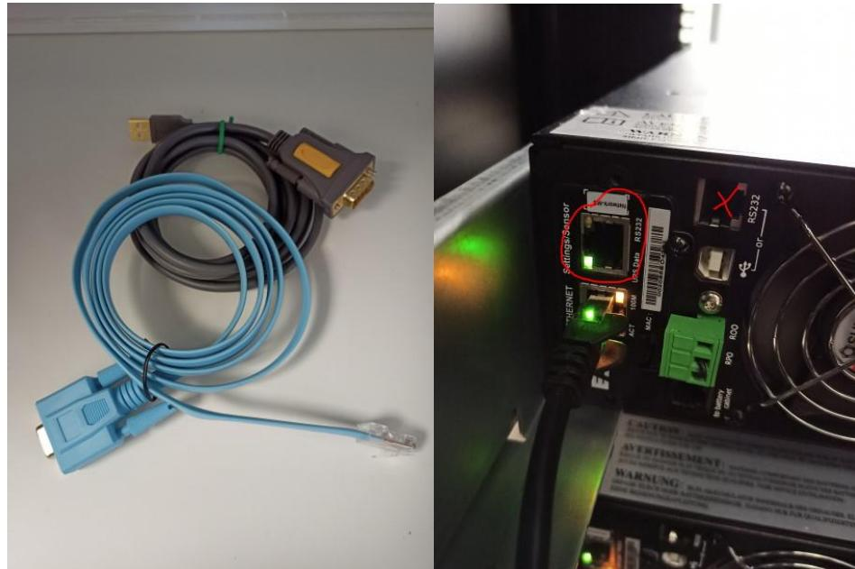
Grâce à HyperTerminal (<https://www.hilgraeve.com/hyperterminal-trial/>) se connecter à l'onduleur avec les paramètres part défaut.
